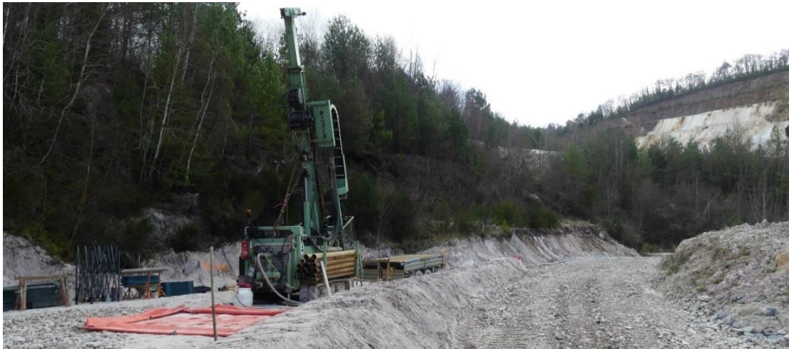
Illustration : Foreuse et matériel en place pour la campagne de sondages Phase 1, le long d'une piste existante – Echassières février 2022 - source photographique : Mica Environnement
