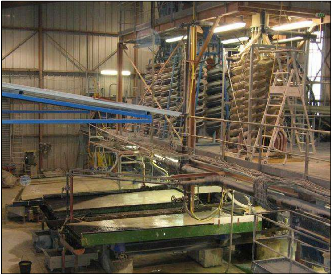
Photographie 7 : Spirales et tables à secousses pour la récupération de l'étain / tantale / niobium
