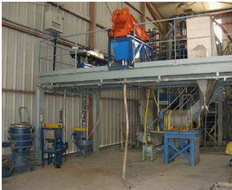
Photographie 22 : Pilote de broyage et de concentration gravimétrique - Kaolins de Beauvoir
