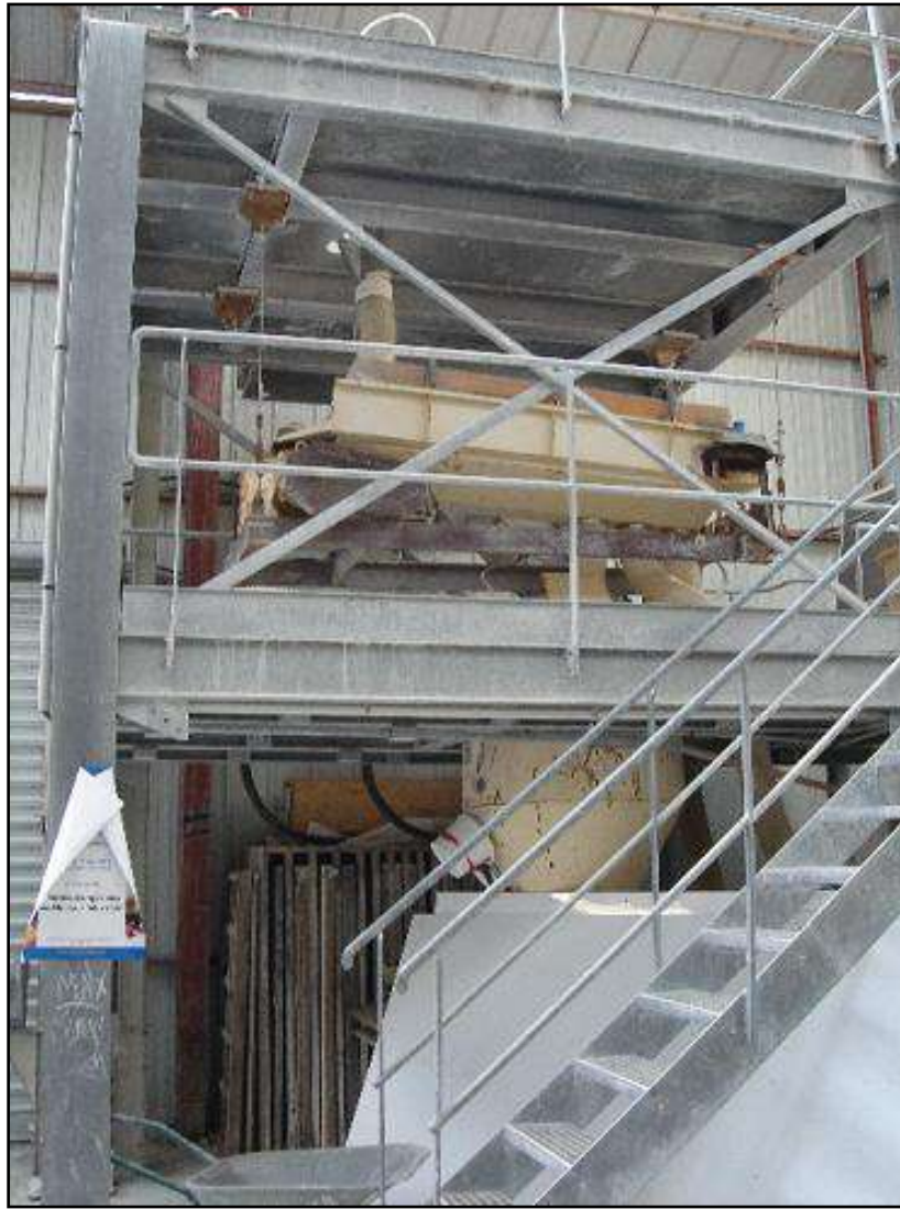
Photographie 19 : Pilote de tamisage en voie sèche - Kaolins de Bretagne
