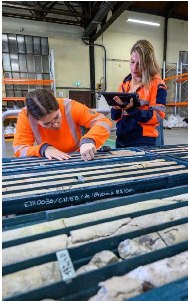
Logging géologique détaillé des carottes, dans la carothèque de Youx
