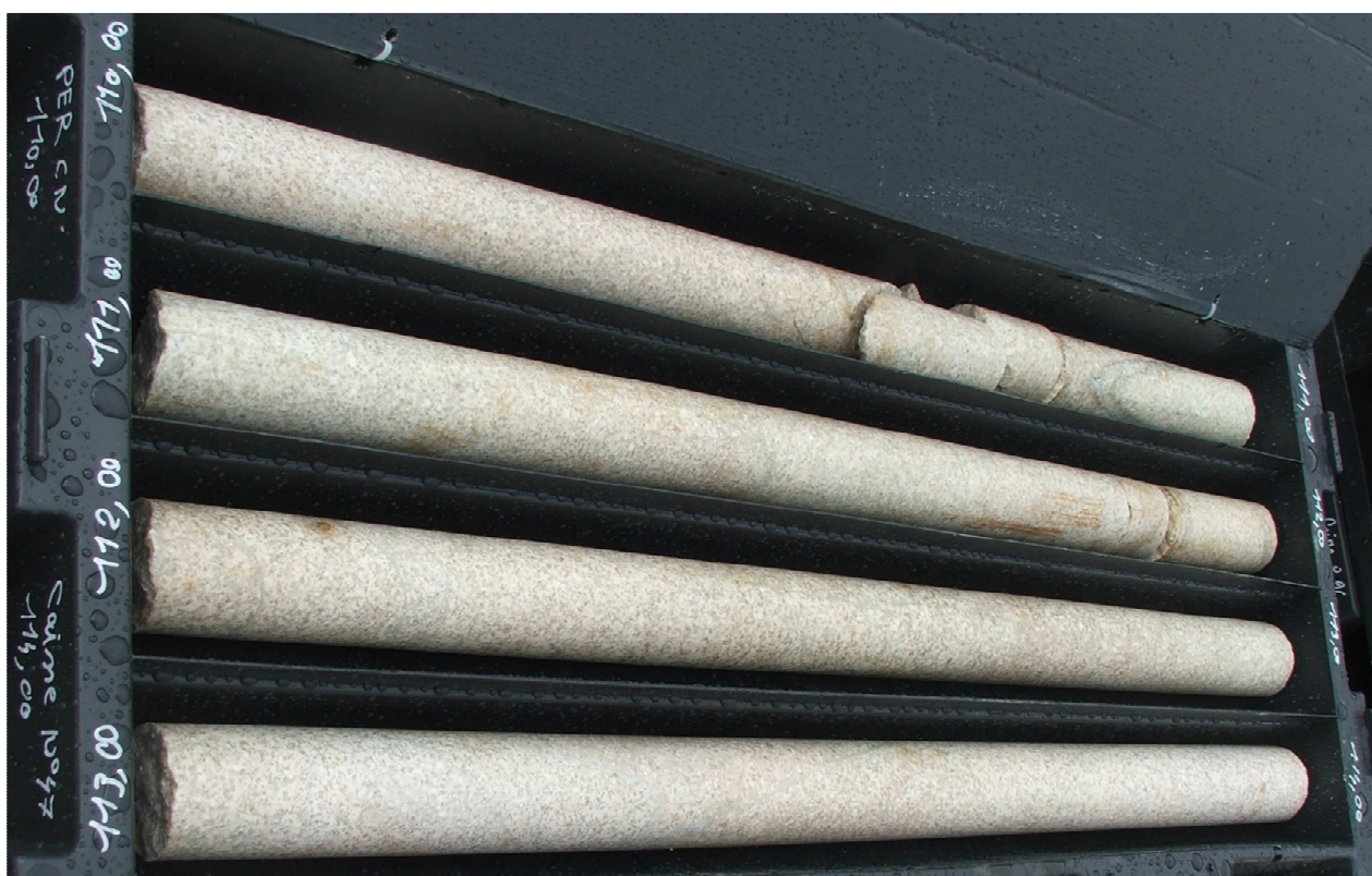
Figure 60: Exemple de carottes obtenues dans le Granite de Beauvoir sain (avant sciage)
