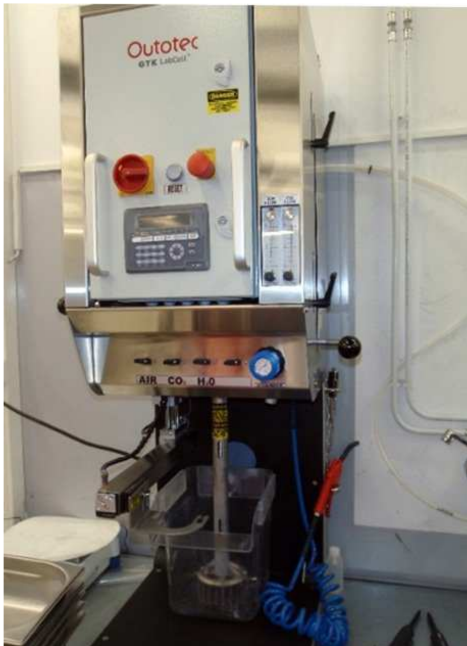
Figure 67: Photographie de la cellule Outotec-GTK (Capture d'image du site internet Outotec)
