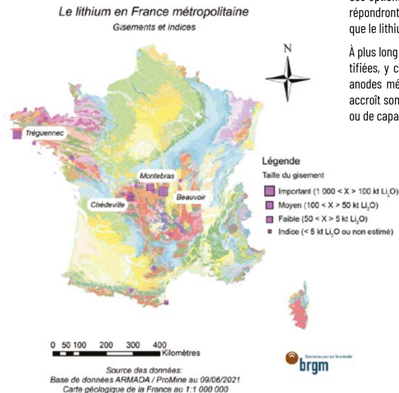
FIG. 3 - CARTOGRAPHIE DES GISEMENTS DE LITHIUM (ROCHE DURE) EN FRANCE (SOURCE - BRGM)
