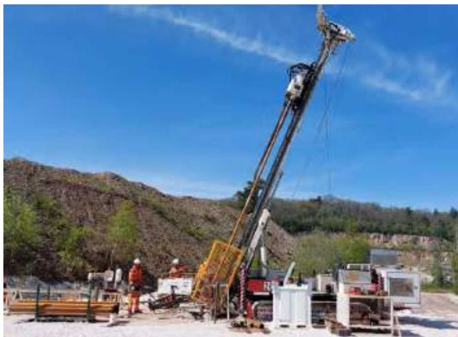
Figure 69 : Exemple de machine de carottage au câble mise en œuvre sur la carrière de Beauvoir (Source - GEOSONIC France)
