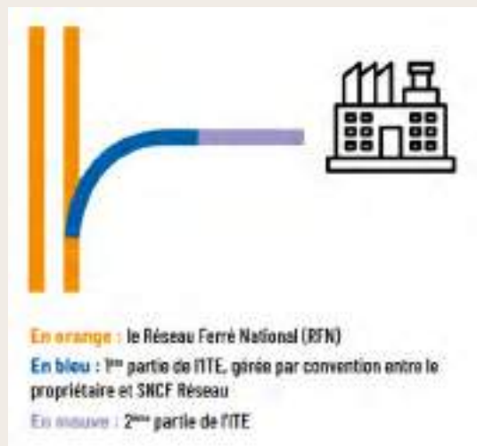
Figure 52 : Schématisation d'une installation terminale embranchée (Source - Imerys)
