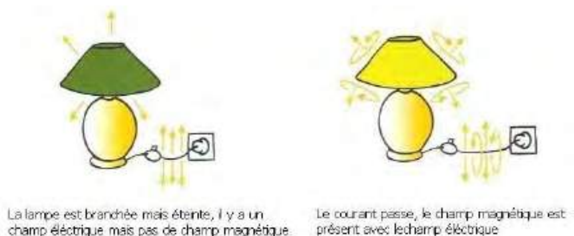
Figure 172 : Principe du champ électrique et magnétique (Source – RTE)
