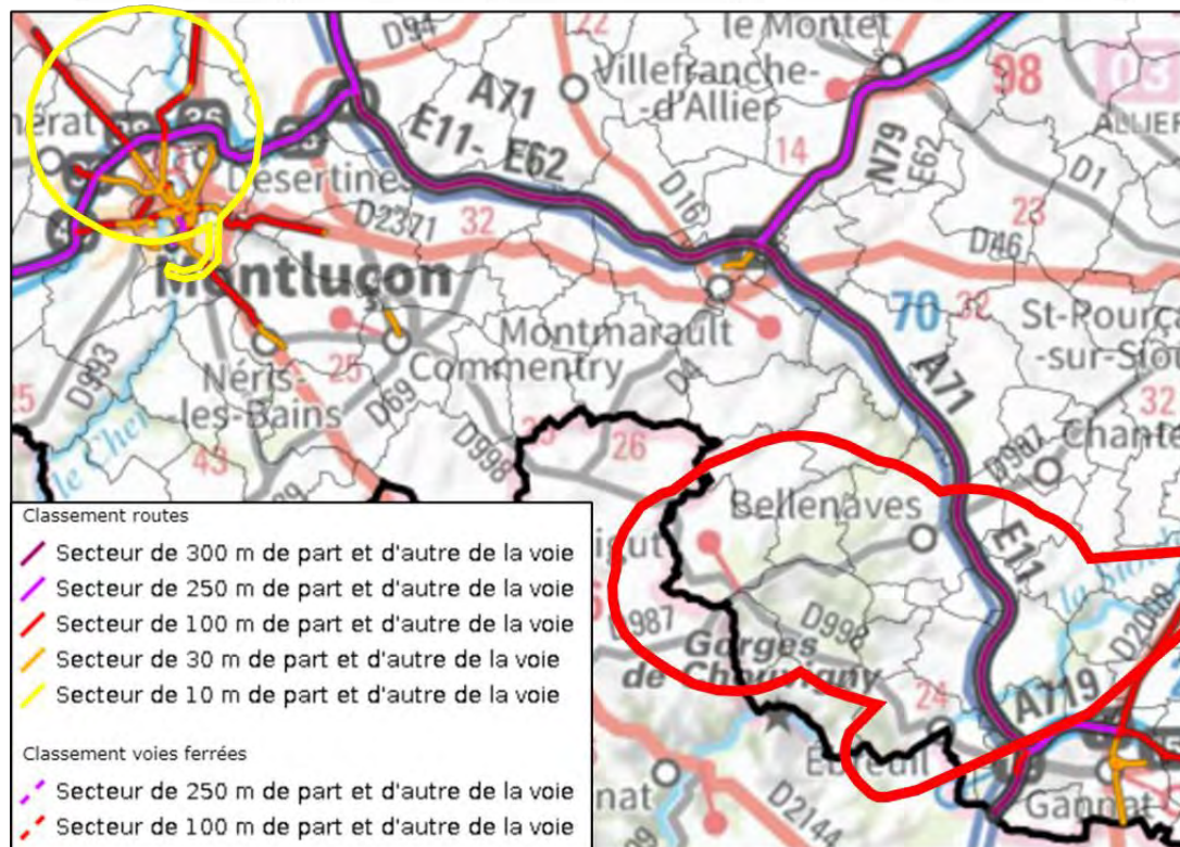
Figure 165 : Classement sonore des infrastructures de transport terrestres au droit de l'aire d'étude éloignée (Source : département de l'Allier)
