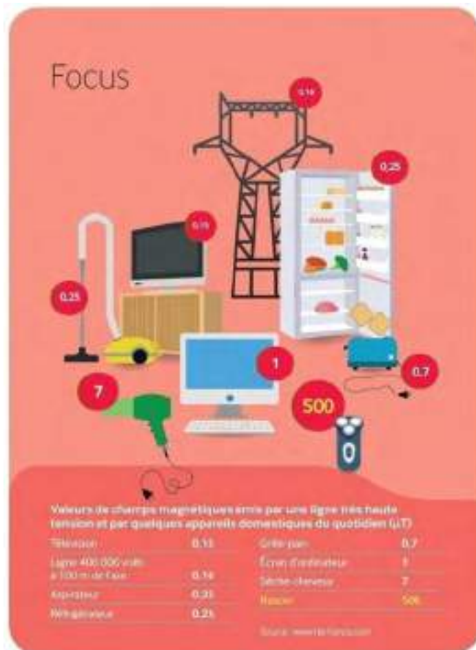
Figure 173 : Valeurs des champs électriques et magnétiques pour quelques appareils ménagers (Source - RTE)
