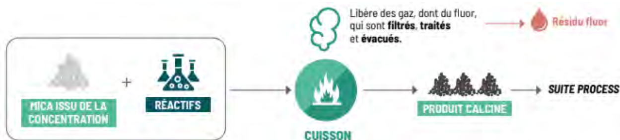
Figure 56 : Schématisation de l'étape de calcination (Source - Imerys)
