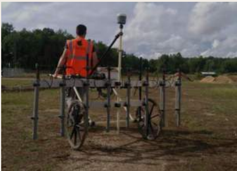
Figure 74 : Diagnostic pyrotechnique par méthode géophysique (Source – Dianex)
