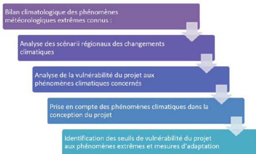
Figure 86 : Présentation des cinq étapes de l'évaluation de la vulnérabilité du projet au changement climatique
